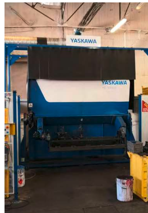
Robot de soudure à 2 tables pivotantes
