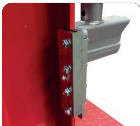
Glissières en laiton avec graisseurs
