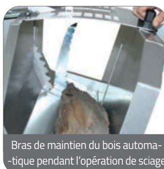
Lame capotée très facilement accessible
