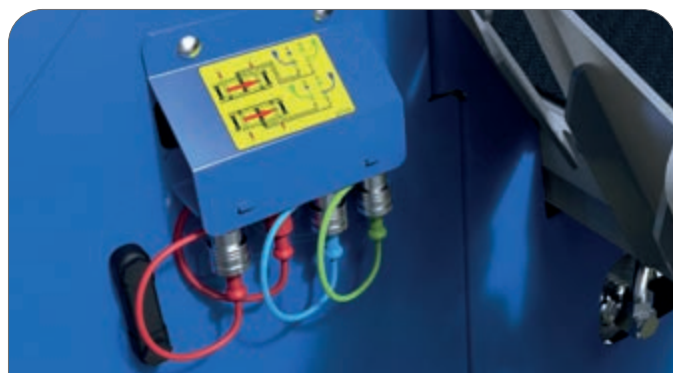
Sortie hydraulique pour deck ou autres accessoires.
