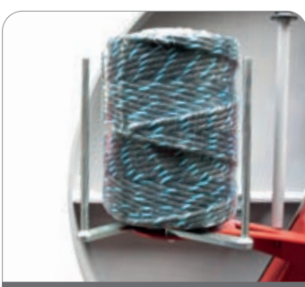
Support de bobine à diamètre réglable
