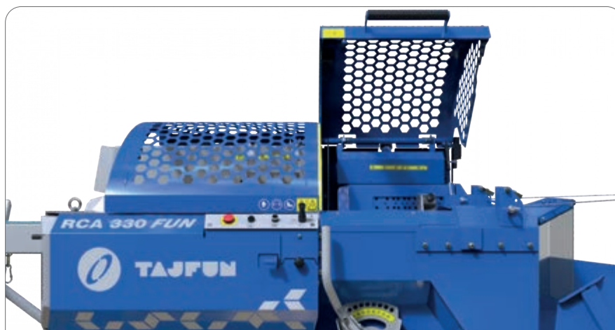
SÉCURITÉ. Le combiné s'arrête dès l'ouverture du capot de protection.
