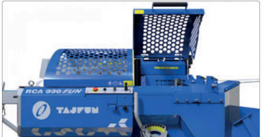
SÉCURITÉ. Le combiné s'arrête dès l'ouverture du capot de protection
