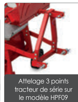
Roue folle pour un déplacement facilité
