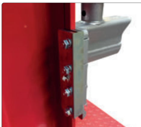
Glissières en laiton avec graisseurs
