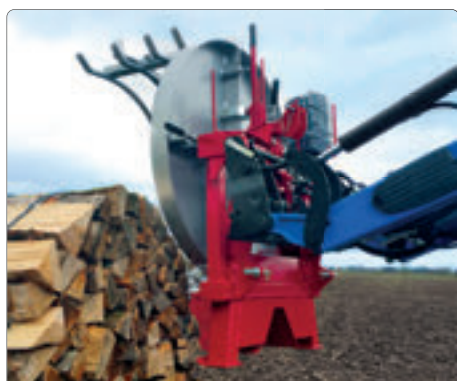
Fagoteuse à bande polyester à basculement mécanique sur 3 points tracteur + attelage euro pour chargeur frontal
