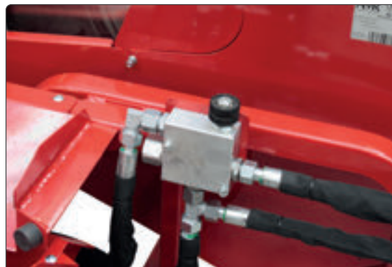
Réglage de la vitesse d'évacuation du tapis de série sur les 2 modèles de SCIOMAT
