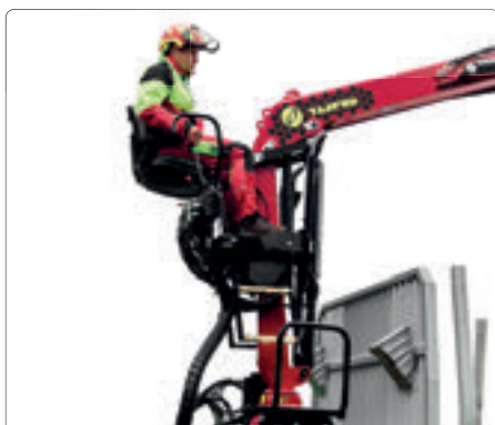
Siège en hauteur ( uniquement sur version GAP 140 + DOT 55 K 85 )
