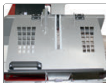
Capot de protection conforme à la norme EN 1870-6-2017
