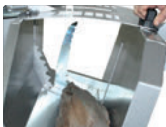
Bras de maintien du bois automatique pendant l'opération de sciage
