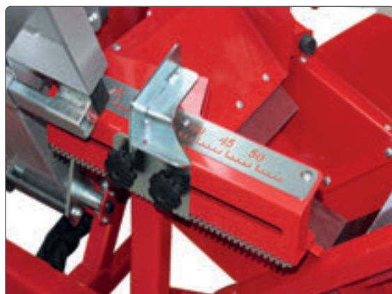
Réglage de la longueur de coupe de 20 à 50 cm.
