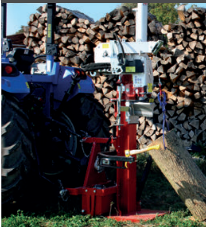
Treuil tire-bûches hydraulique à commande mécanique avec pince.
